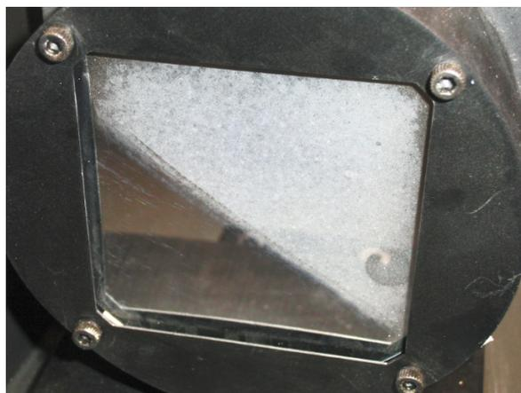
**Abb. 26:** Ursprungszustand der Spiegel vor der Reinigung mit Aceton (oberes Dreieck)
