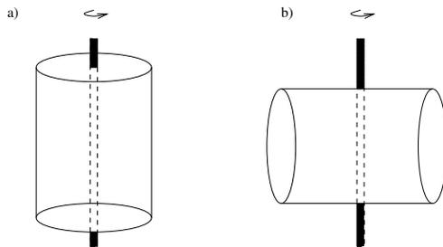
Abbildung 2: Hauptträgheitsachsen eines Zylinders
