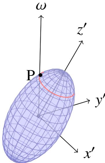
Abbildung 1: Trägheitsellipsoid für den Fall, das die Hauptträgheitsachsen des Körpers nicht mit dem Koordinatensystem  $(x', y', z')$  zusammenfallen. Der Abstand zwischen dem Schwerpunkt S und Durchstoßungspunkt der Rotationsachse durch die Ellipsoidoberfläche P ergibt das Trägheitsmoment der Körpers bezogen auf die Drehachse  $(\overline{SP} = \frac{1}{\sqrt{J_A}})$ .
