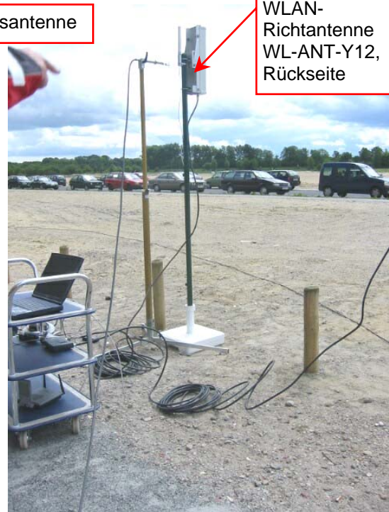
Foto 4: Messaufbau Richtantenne, Abstandsmessung an der Antennenrückseite ab Gehäuserückseite
